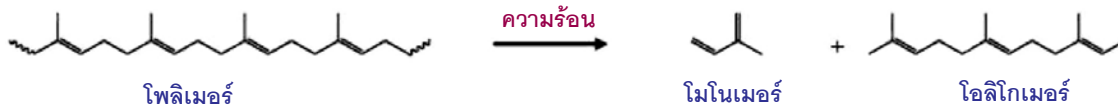
รูปที่ 1 ตัวอย่างแสดงการสลายตัวของโพลิเมอร์เมื่อได้รับความร้อน
