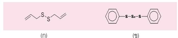
รูปที่ 1 โครงสร้างของสารรีเคลม (ก) ไดเอริลไดซัลไฟด์ และ (ข) ไดฟีนิลไดซัลไฟด์
