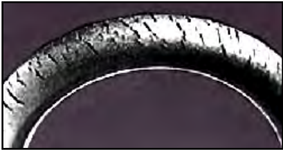
รูปที่ 1 ตัวอย่างรอยแตกที่เกิดจากโอโซน
