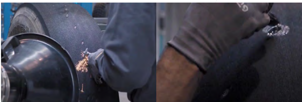
รูปที่ 11 การเจียรไนเพื่อตัดแต่ง และเคลือบด้วยซีเมนต์
