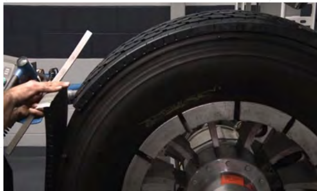
รูปที่ 14 การติดดอกยางใหม่รอบโครงยาง สำหรับหล่อดอกยางแบบเย็น
