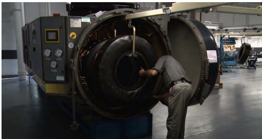
รูปที่ 17 หม้ออบความร้อน ซึ่งควบคุมความดันและอุณหภูมิสำหรับการหล่อดอกลายแบบเย็น
