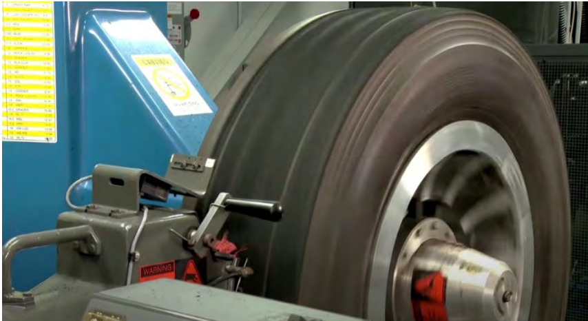
รูปที่ 7 การขัดเพื่อนำวัสดุดอกยางเดิมออกด้วยเครื่องจักรแบบกลึง
