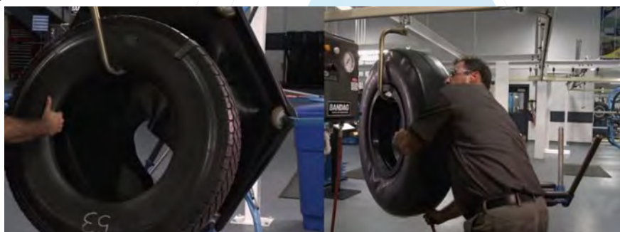
รูปที่ 16 โครงยางที่ครอบด้วยแผ่นห่อหุ้มยาง (Envelope) สำหรับการหล่อดอกยางแบบเย็น
