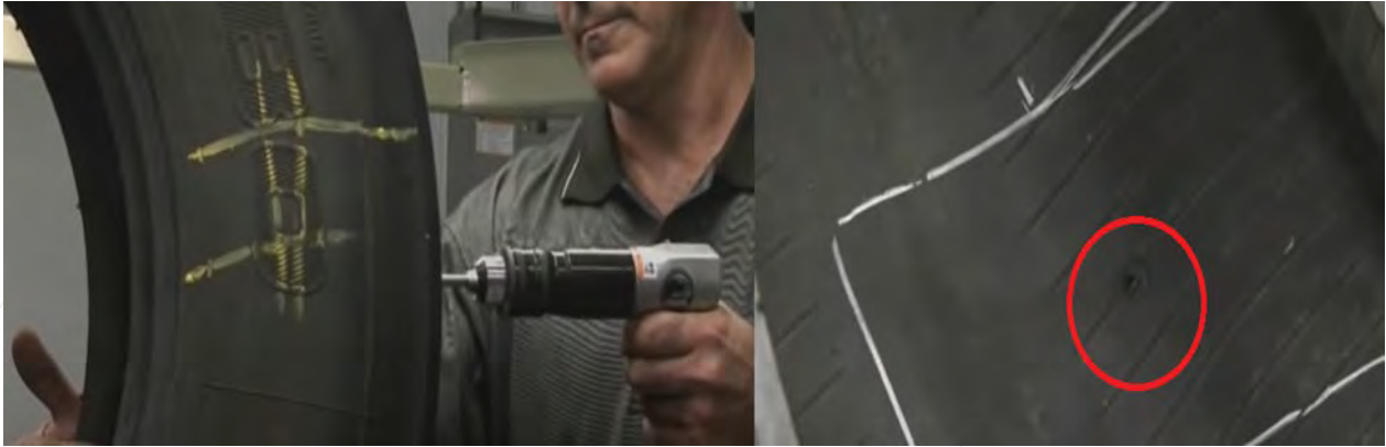
รูปที่ 12 การเจียรระไนเพื่อทำความสะอาดรอยแผลรูทะลุ
