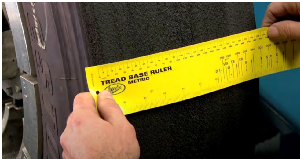
รูปที่ 10 การวัดขนาดโครงยาง เพื่อหาขนาดที่เหมาะสมกับดอกยาง
