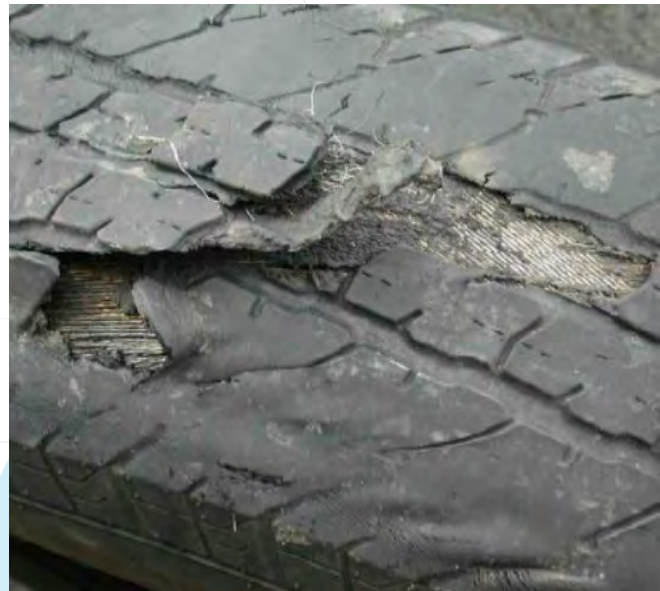
6. ความเสียหายจากการสึกหรอของยาง (worm tread)
