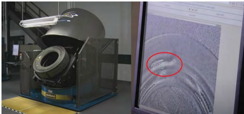
รูปที่ 9 การตรวจสอบโครงยางด้วยเครื่องมือทดสอบแบบซีโรกราฟี
