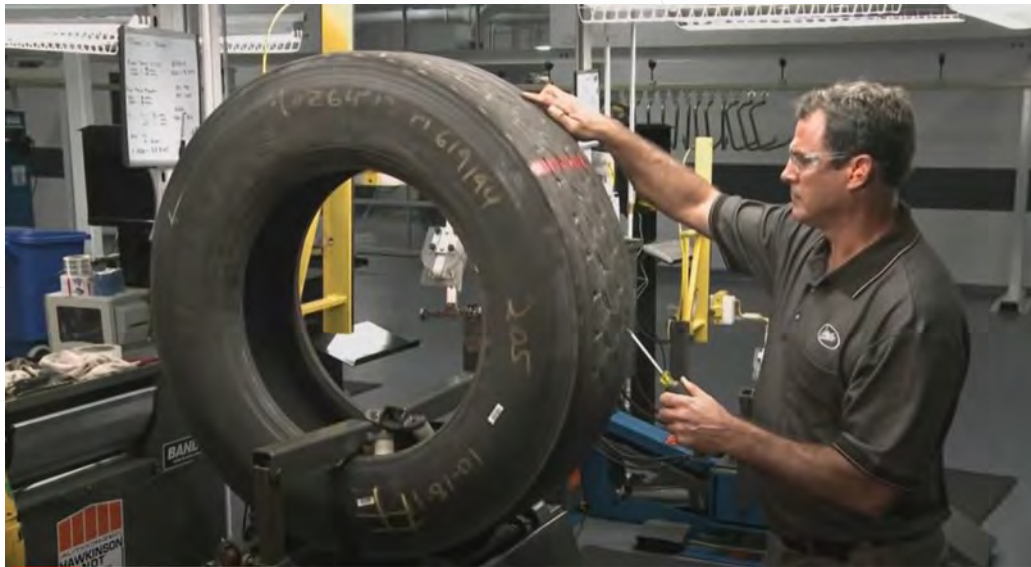
รูปที่ 6 การใช้เครื่องจักรถ่างหมุนตรวจสอบยางล้อ ในการตรวจสอบเบื้องต้น
