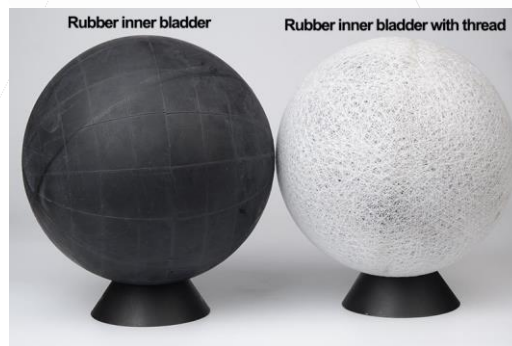
รูปที่ 3 ลูกบอลยางในแบบไม่มีกาว (สีดำ) และมีกาวพัน (สีขาว)
