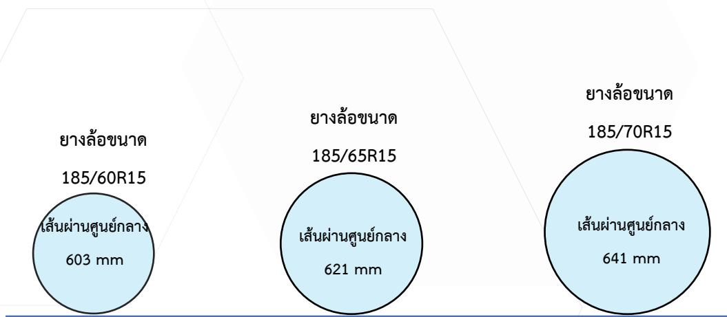
รูปที่ 7 ความสัมพันธ์ของความสูงหน้าตัดยางล้อกับเส้นผ่านศูนย์กลางยางล้อที่เปลี่ยนแปลง
