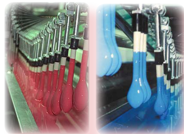
รูปที่ 2 ตัวอย่างการจุ่มแม่พิมพ์ลงในน้ำยาง
